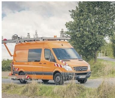
Messfahrzeug für Messung der Straßenebene und Substanzmerkmale.
